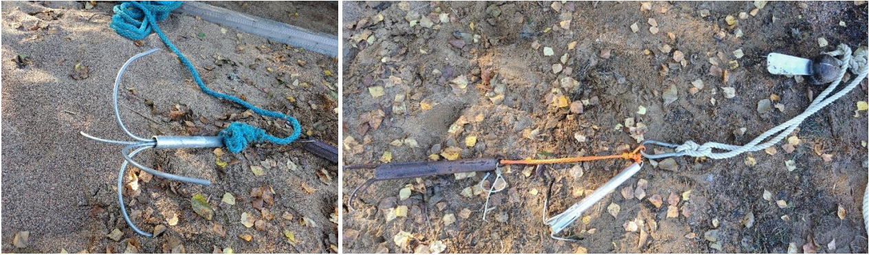
Kuva 2. Naaraan on kiinnitetty painokuula, joka pitää koukut pohjan tuntumassa. © WWF/ Teemu Niinimäki
