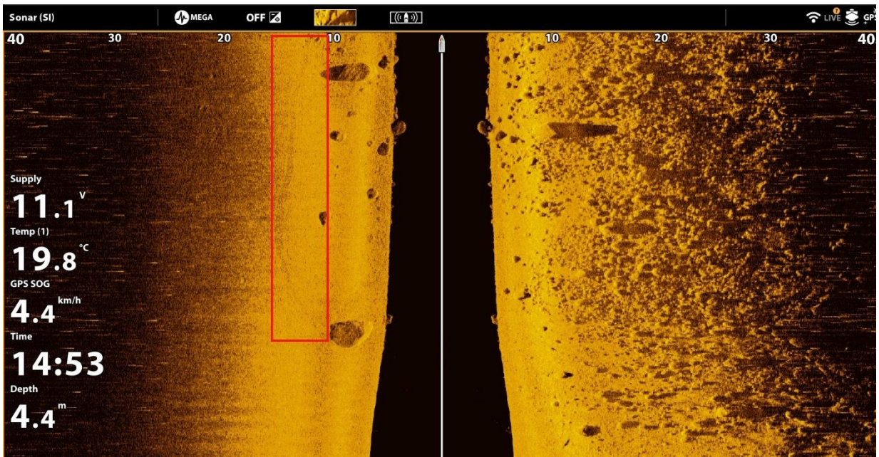
Kuva 3. Viistokaikuluotaimen kuvassa verkon alapaulan pohjaan tekemä jälki. Verkon havaitsemistarkkuuteen vaikuttaa paljon luotaimen asetukset ja ruudun vieritysnopeus suhteessa luotausnopeuteen. Viistokaiulla saadaan katettua leveähkö kaista, mutta näytöstä riippuen, ohuen verkkopaulan havaitseminen pelkältä sidescan-näytöltä voi olla haasteellista. © WWF/ Ismo Marttinen
