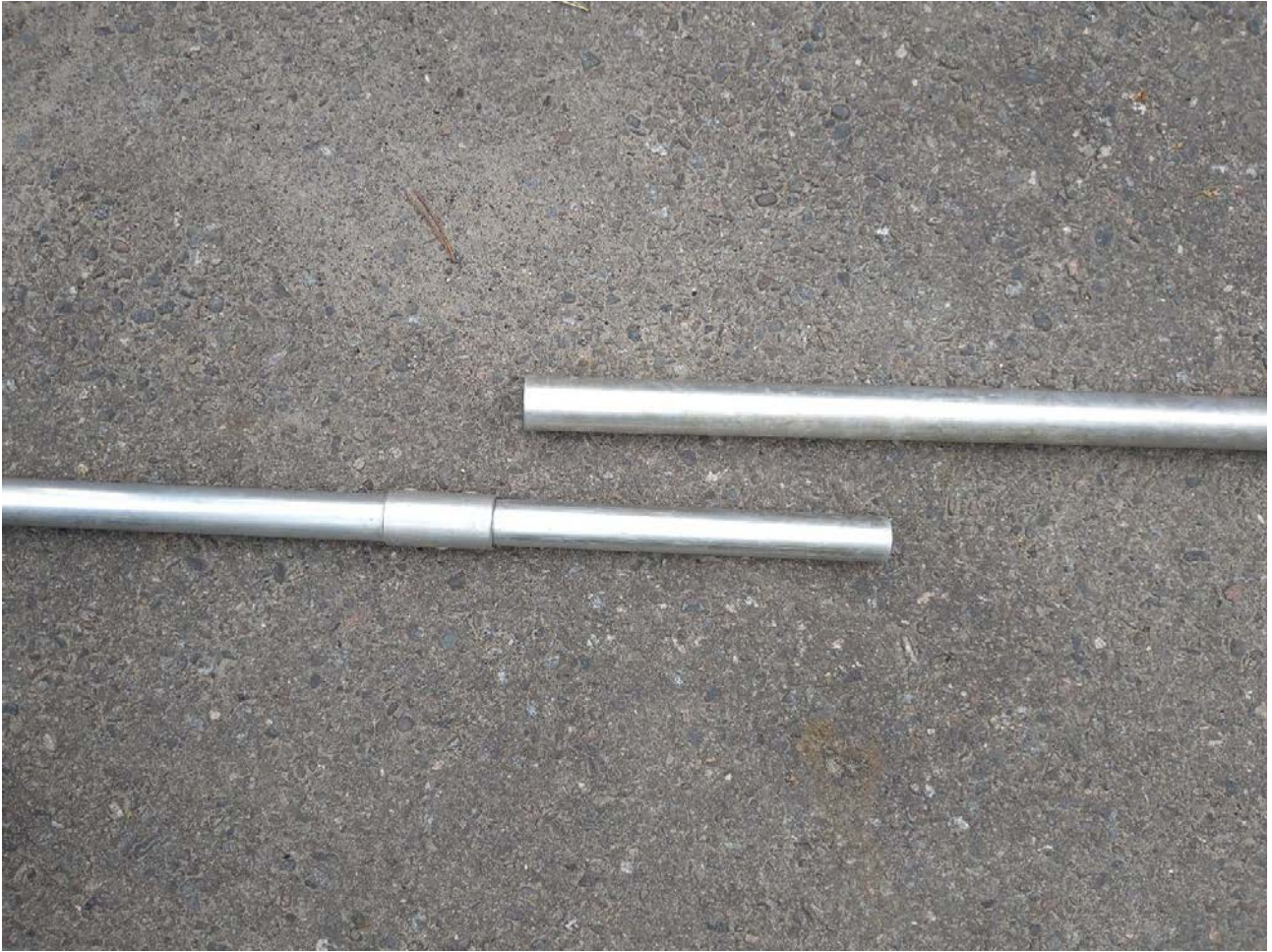
Valokuva 14. koottavan puomin liitos voidaan tehdä esimerkiksi näin. Ohuempi (30 mm) putki menee paksumman (35 mm) sisälle stoppariin asti.
