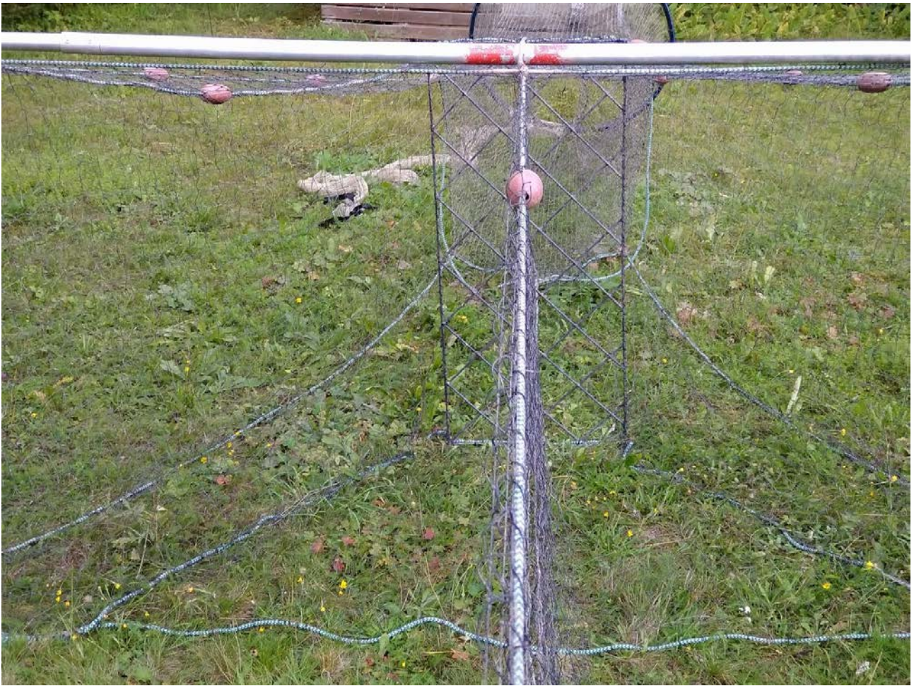
Valokuva 5. Näkymä aidalta rysän nieluihin ja perään päin. Etupesän nielussa näkyy norpanestokalteri. Etupesän pohjassa on lyijypaulat ja sen katossa köydet kohoineen. Rysän perän vieressä näkyvä vaalea havas on koentasukka. Puomi on keskeltä kiinni yläpaulassa, Aitaverkon yläpaula jatkuu kalterille asti ja se kiinnitetään kalterin yläreunaan.
