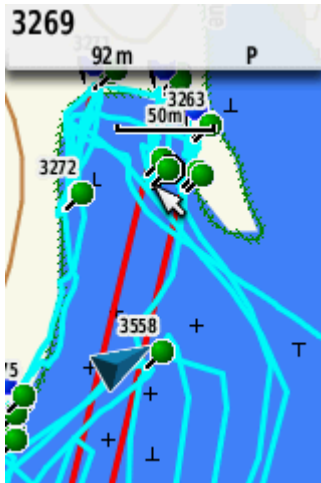
Kuva 4. Etäisyyden mittaaminen reittipisteeseen GPS-laitteella.
