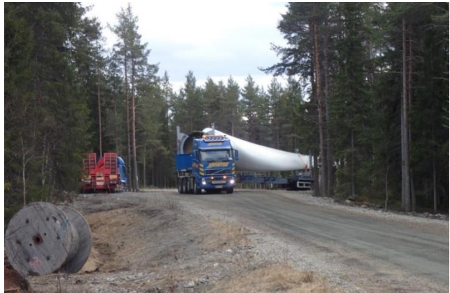
Kuvapari 5-7. Vasemmalla esimerkki tuulivoimapuiston rakennus- ja huoltotiestä. Oikealla tuulivoimalan osia kuljetetaan erikoiskuljetuksina (Kuvat: Ville Suorsa/FCG).
