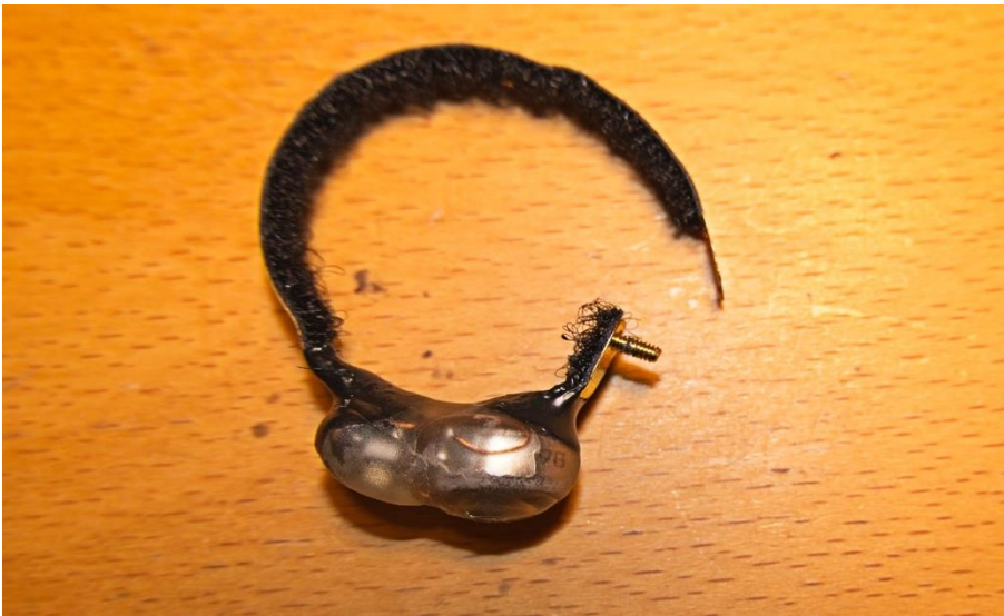
Kuva 2-3. Käytetty radiopantamalli. Valmistaja Lotek UK. Tag type Brass, Tx PIP3, Mode Pulse Length 12 Mode pulse rate 44 Life >14,5 month, Max weight: 4,95g. Pannan sisäpuolella on keinokuituinen kähärä pehmuste, jonka kuituja voi kuitenkin tarttua myös kiinnitysruuvien uriin, ja ajan myötä pehmusteen havaittiin myös lähtevän pois.
