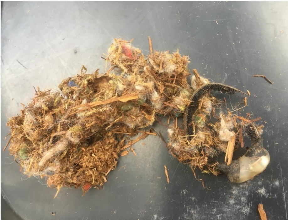
Kuva 3-2. Oskun panta pesänpohjan seassa. Panta on auennut, mutterit ovat irronneet. Kun panta aukeaa, sen lähetysteho putoaa selvästi ja löytämismahdollisuus heikkenee.
