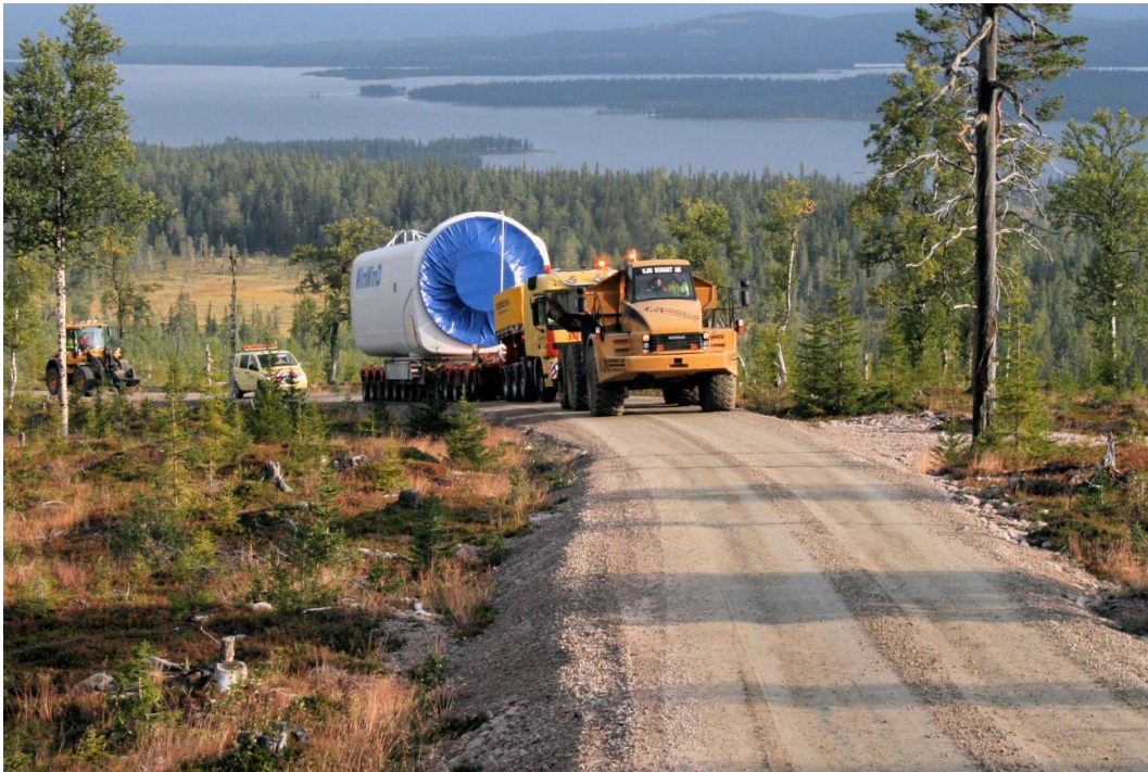
Kuva 3-13. Tuulivoimalaitoksen koneiston kuljetusta. (Kuva: WinWinD, www.winwind.com ).
