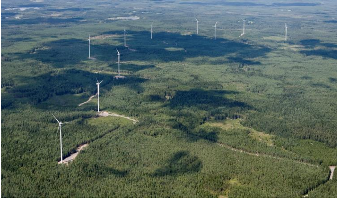
Kuva 3-6. Tuulipuisto metsäisellä alueella. Stengårdsholman tuulipuisto Ruotsissa, 10 voimalaa à 2 MW, napakorkeus 125 m, roottorin halkaisija 90 m. (Kuva: EON).
