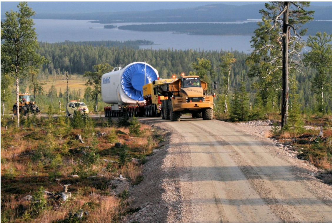
Kuva 6. Tuulivoimalaitoksen koneiston kuljetusta. Kuva: WinWinD ( www.winwind.com )
