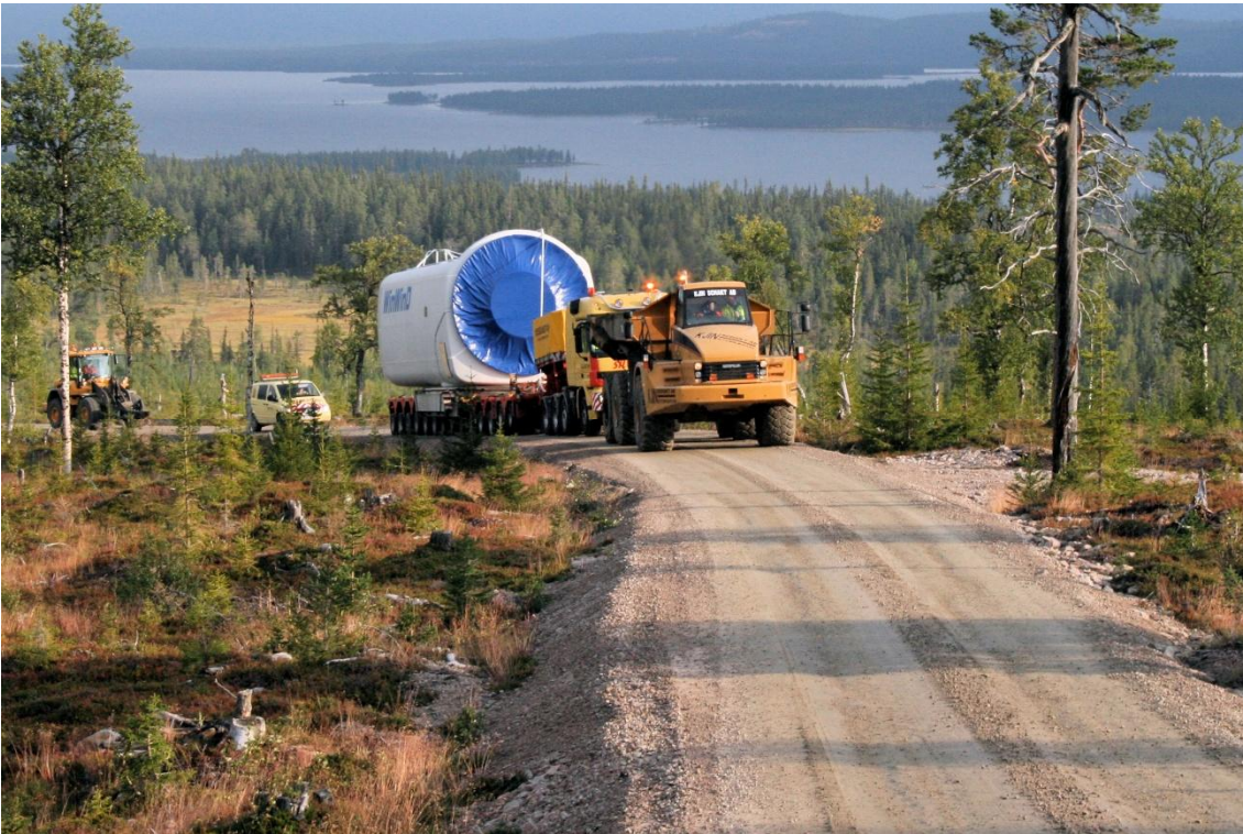
Kuva 7. Tuulivoimalaitoksen koneiston kuljetusta. Kuva: WinWinD ( www.winwind.com )
