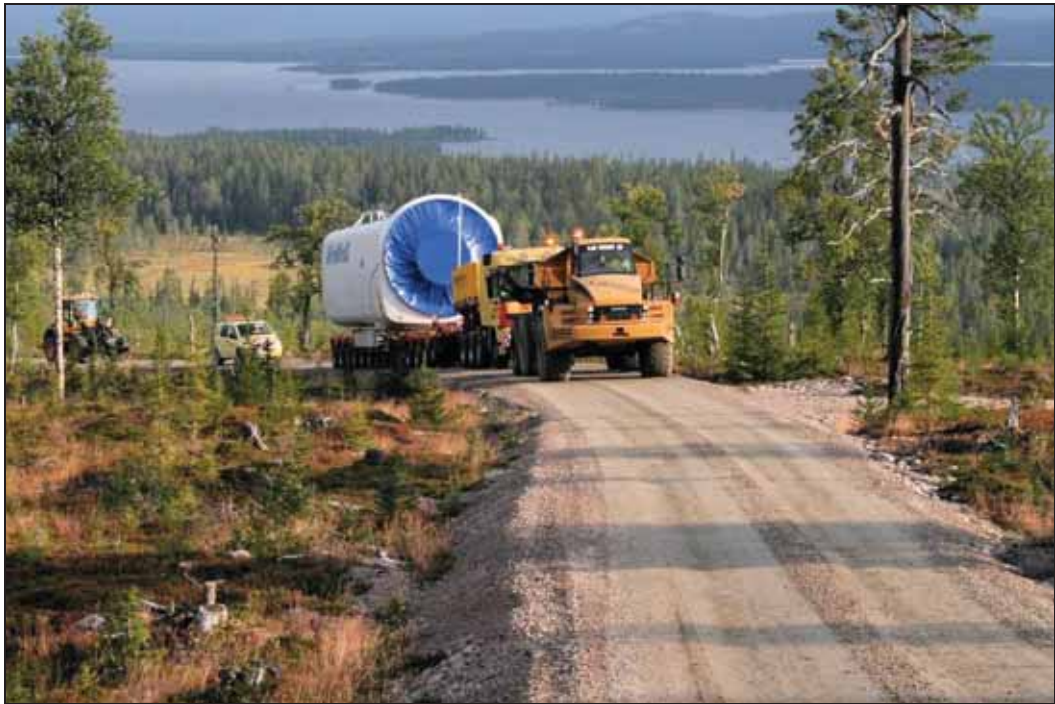
Kuva 3-14. Tuulivoimalaitoksen koneiston kuljetusta. (Kuva: WinWinD, www.winwind.com ).
