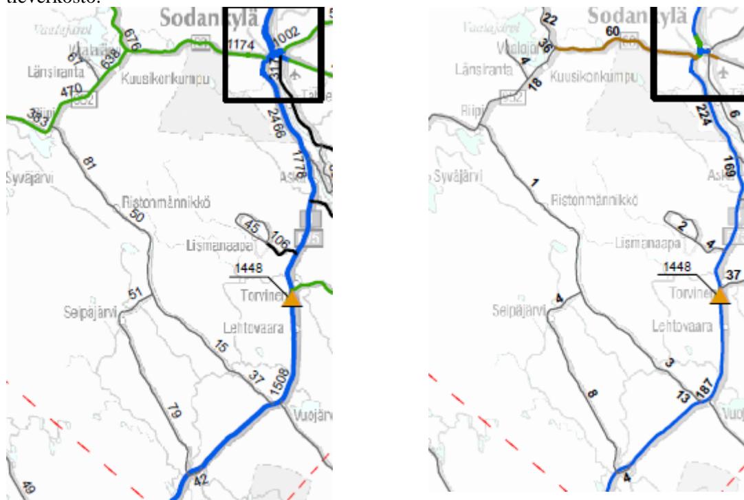
Kuva 49. Hankealueen lähialueen tiestön liikennemäärät ajoneuvoa vuorokaudessa (Lapin ELY-keskus, 2011). Oikeanpuoleinen kuva esittää raskaan liikenteen liikennemääriä, vasemmanpuoleinen muuta ajoneuvoliikennettä.
