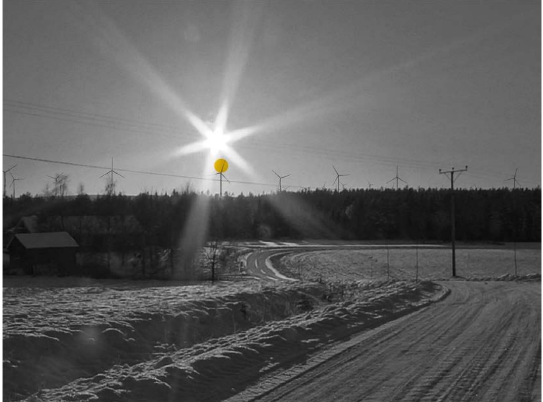
Kuva 33. Kuvasovite Pyykkölänvaaralta. Teoreettinen havainnekuva tilanteesta, jossa noin 4 km etäisyydellä olevan tuulivoimalan siiven vähäinen peitto auringon edessä (keltainen ympyrä) ei aiheuta laskennallista vilkkumista.
