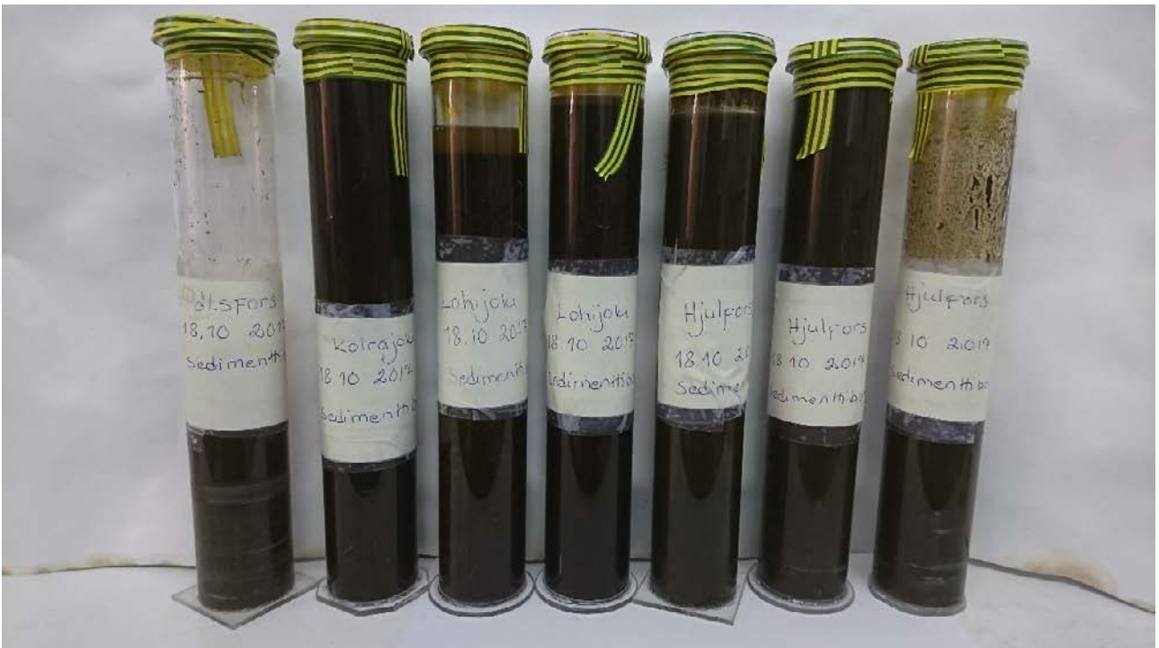
Kuva 15. Sedimentaatorasioihin kertynyt kiintoaines sedimentaatioputkiin siirrettyinä
