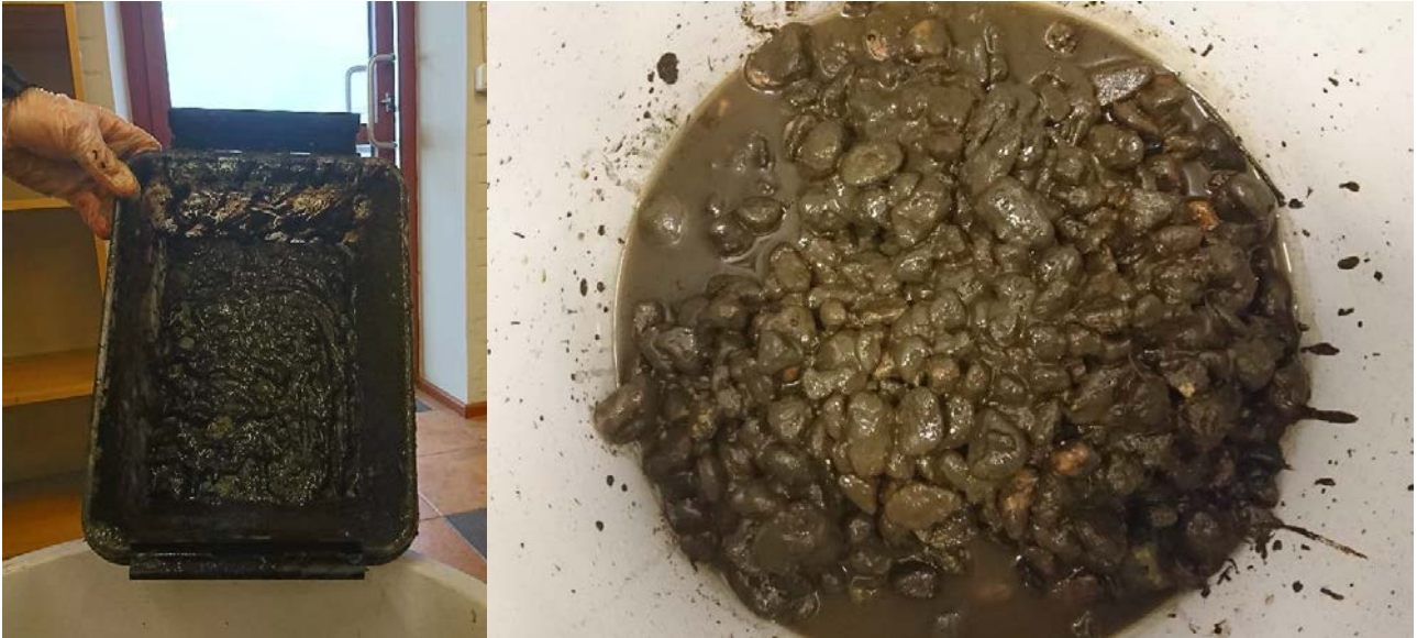
Kuva 14. Hjulforsin sedimentaatoriasiaan kertynyt kiintoaines
