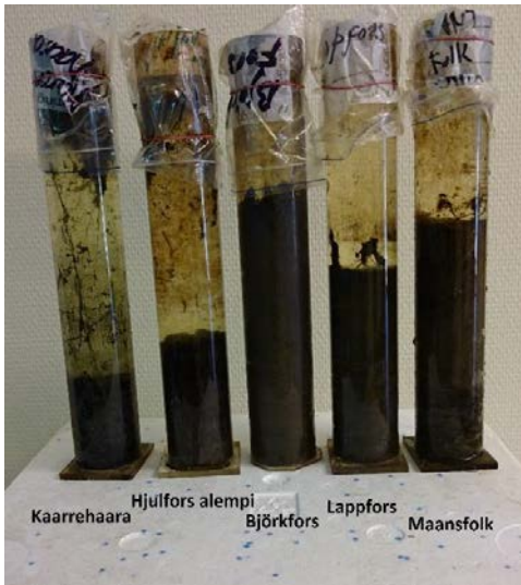
Kuva 4. Kesällä 2016 eri mittauspisteiltä sedimentaatioputkiin kertynyt kiintoaines.
