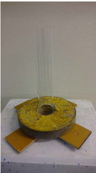
Kuva 3. Sedimentaatioputki ja teline
