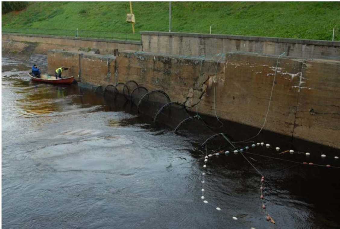
Kuva 12. Merikosken alakanavassa useana vuonna pyynnissä ollut rysä, jolla kalatietutkimuksissa seuratut tutkimuslohet ja taimenet on pyydetty. Lähde: Orell ym. (2014).
