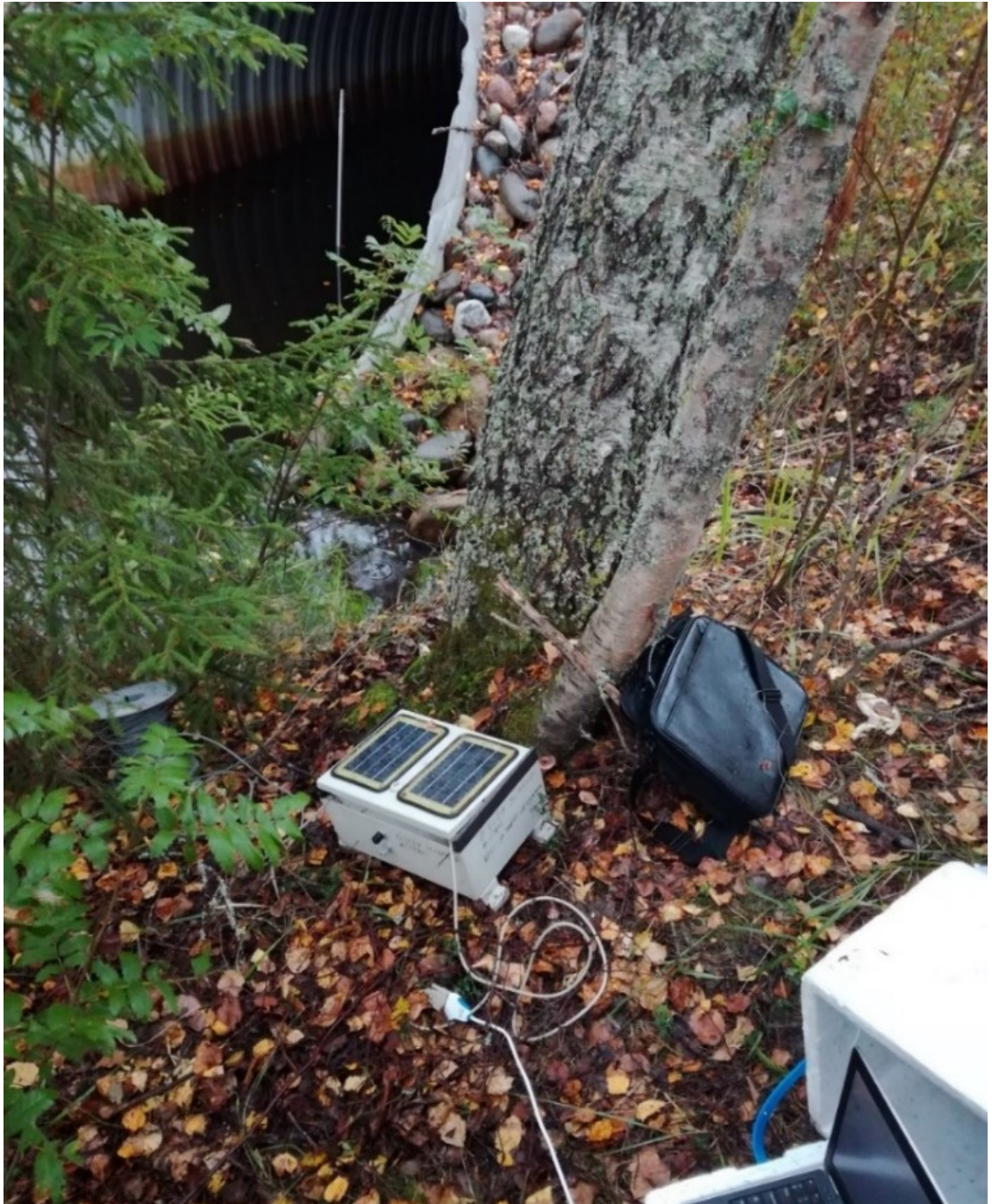
Kuva 21. Virtaamamittaus Haukolanjoesta SonTek-IQ Plus –virtausmittarilla (kuva: Uusitalo J., 2018).
