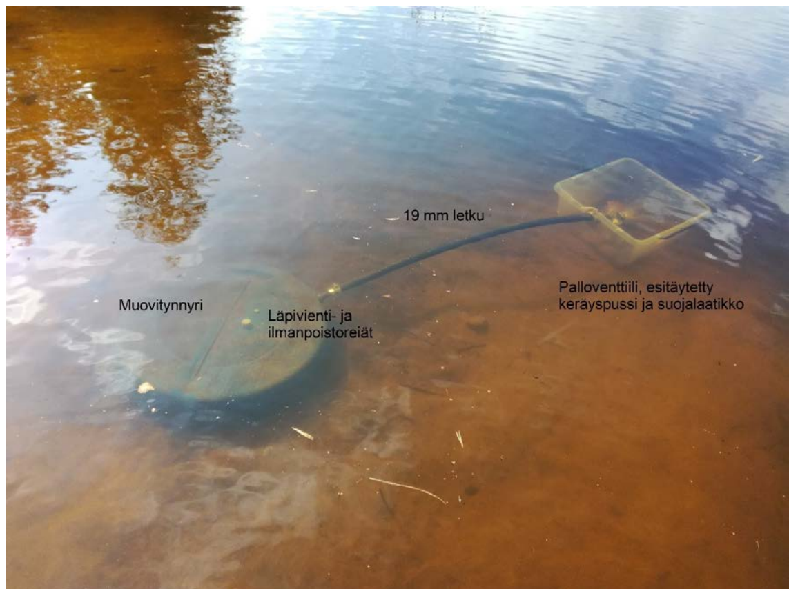
Kuva 19. Suotautumismittaus käynnissä Ristilahdella (kuva: Uusitalo J., 2018).
