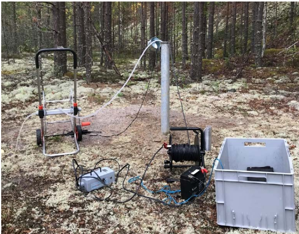
Kuva 15. Pohjavesinäytteenotto SS-Monsoon uppopumpulla havaintopaikalla HaPa E3118 (kuva: Huotari E., 2018).
